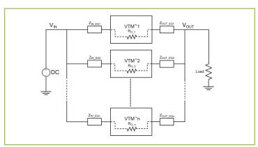
Figure 20 — VTM module array
