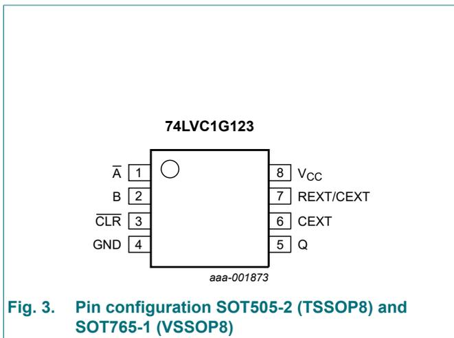
Fig. 3. Pin configuration SOT505-2 (TSSOP8) and SOT765-1 (VSSOP8)
